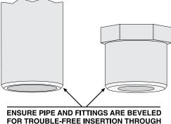
EXHAUST AND INTAKE PIPE GASKETS
